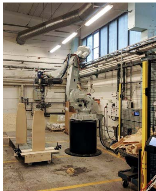
En ABB-robot med ett skrivarhuvud för biokompositer skriver ut en halv surfingbräda i trä. Brädan skrivs ut i två delar som sedan fogas samman.
