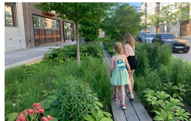
Exempel på öppen dagvattenhantering i N. Djurgårdsstaden, Stockholm
