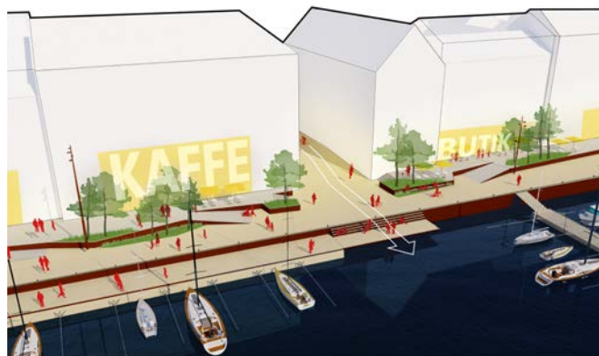
Exempel på byggnader med mellanliggande skydd som tillsammans skyddar innanförliggande stad mot översvämning vid en högvattenhändelse
